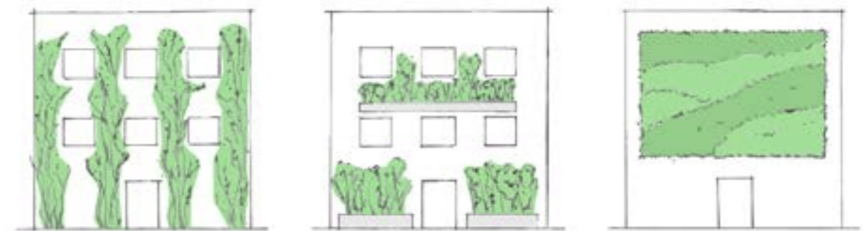
Abb. 17: Bodenengebundene, troggebundene und fassadengebundene Vertikalbegrünung
